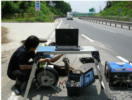
【관로 부단수 내시경 검사 장비 및 검사 개요도】
